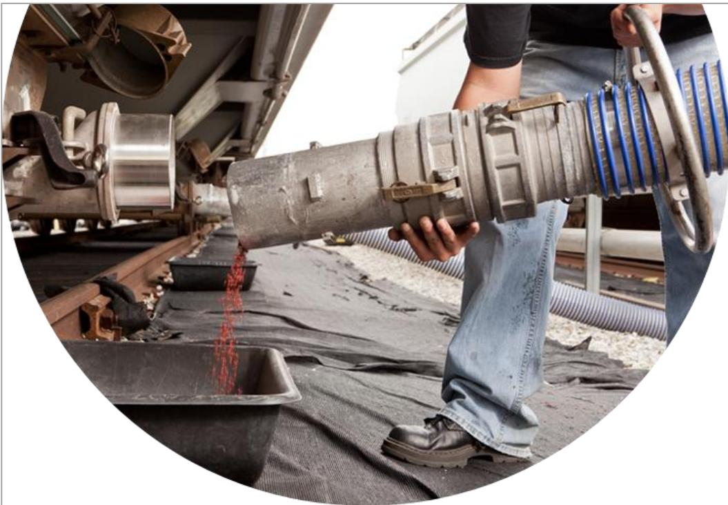
Figura 11. Equipamento de contenção de pellets para reduzir a perda de pellets da indústria para meios marinhos (Fonte: OceanSweep, 2014)
